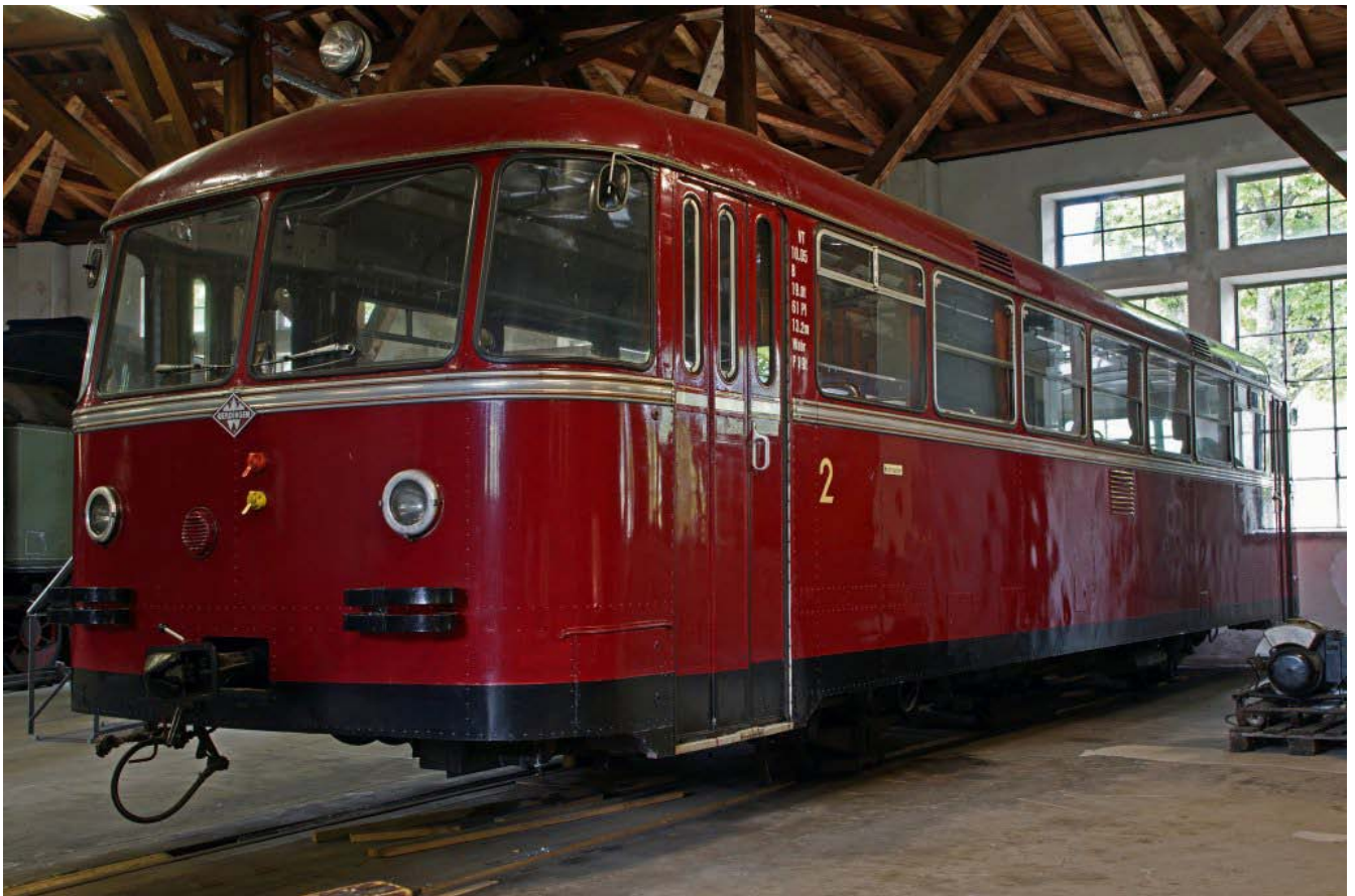
Schienenbus, Bj. 1955, 2x150PS, Vmax 90 km/h
